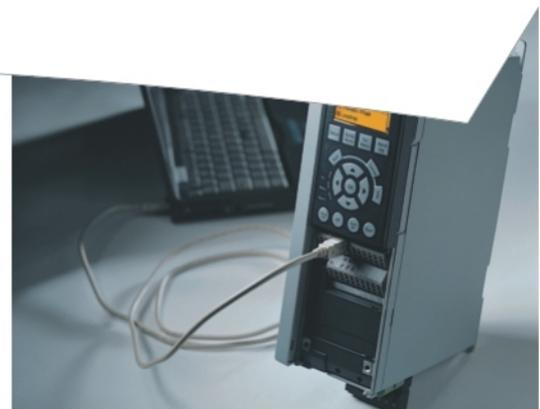
對VLT®HVAC變頻器可通過USB電腦連接界面或建築樓宇管理系統網路通訊進行遠端試運行和監測。採用VLT®安裝軟體MCT10和語言選擇器，使變頻器的操作如同兒童做遊戲一般輕鬆簡單。
