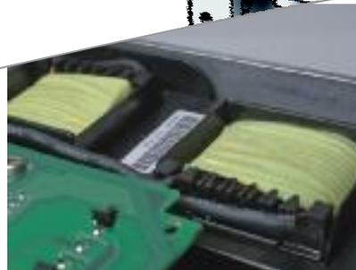
直流電抗器降低諧波電流，保護變頻器。而且，也內置了電磁兼容性濾波器（符合EN61800-3的C3、C2和C1標準）。
