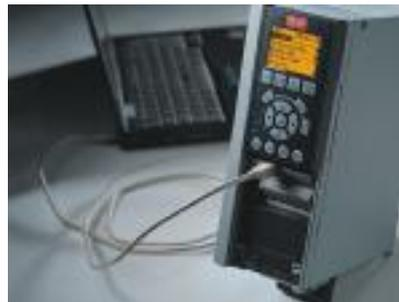
VLT®AQUA系列變頻調速器USB介面可插式電纜進行遠端調試和監測。VLT®MCT 10調試軟體真正使變頻調速器的操作輕鬆簡單。
